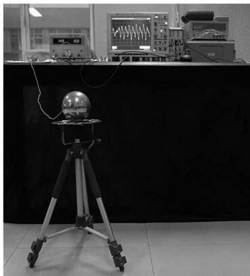
图3 步伐静电信号测量装置
